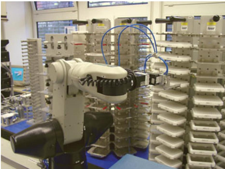
**Abb.:** *Automatisierung im Humangenomprojekt. Roboter dieser Art bereiten die Proben für die eigentliche Sequenzierung vor. Jede der Platten enthält 384 Reaktionskammern, bei einem Durchlauf können in zweieinhalb bis drei Stunden zwölf Platten mit insgesamt 4.608 Proben bearbeitet werden.*
