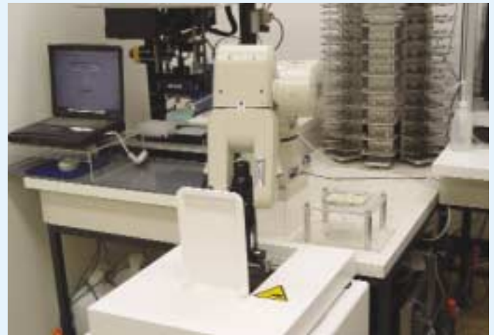
Abb. 2: a) Vollautomatisierte Robotikanlage zur Durchführung der PCR- und Sequenzierungsreaktionen; b) zur Aufreinigung der PCR-Produkte.
