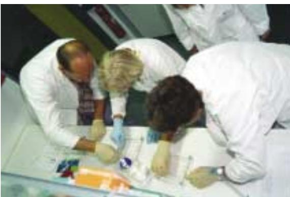
*Vorbereitung der Gelkammern zur elektrophoretischen Trennung von DNA-Molekülen*
