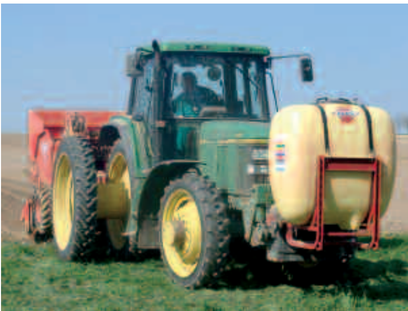
Abb. 1: Kartoffel-Pflanzmaschine mit aufgesatteltem Behälter zur flüssigen Pflanzgutbeizung
