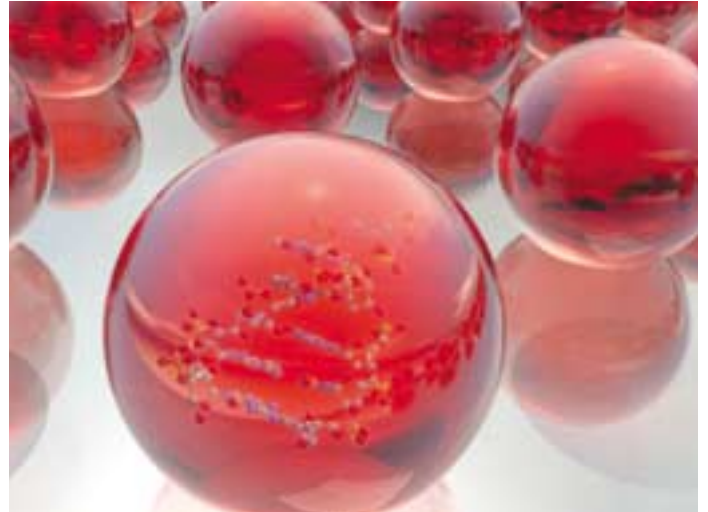
«Verankerte Nanotröpfchen» auf SCIENION-BioChips – Modell von stehenden, DNA-Moleküle enthaltende Tropfen, die als wandfreie Reaktionsgefäße für biomolekulare Tests dienen.
