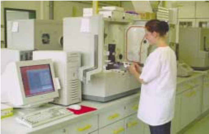
Fragmentanalyse im Hochdurchsatz auf Kapillarelektrophorese- geräten bei TraitGenetics GmbH
