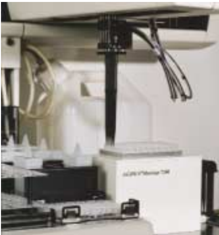
links: Vollautomatische Extraktion von Nukleinsäuren mit Hilfe der Magnetseparation
