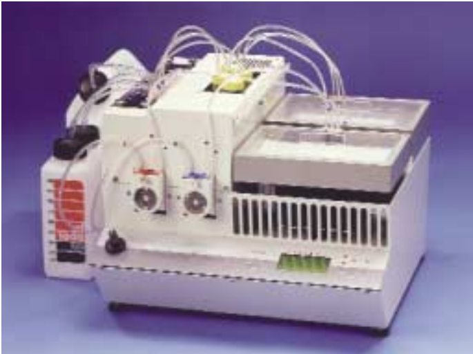
Abbildung 1: BioLane Zur Entwicklung des Detektionssystems wird der Laborautomat BioLane HTI (Homogenous Temperature controlled Incubator) der Hölle & Hüttner AG verwendet.
