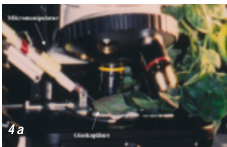
Abb. 4: Arbeitsschritte auf dem Weg vom Einzelzellsaft zum Genexpressionsprofil: Sammeln des Zellsaftes aus einem einzelnen Trichom (a,b), Glaskapillare mit Extrakt aus einer einzelnen Zelle (c), Herstellung der cDNA mittels RT-PCR (d,e) und Ausschnitt aus einem DNA-Chip, der mit der fluoreszenzmarkierten cDNA hybridisiert wurde (f). RT = reverse Transkription; M = DNA-Marker; E-Ko, T-Ko = Kontrolle für DNA-Kontaminationen bei Epidermis- bzw. Trichomzellproben.
