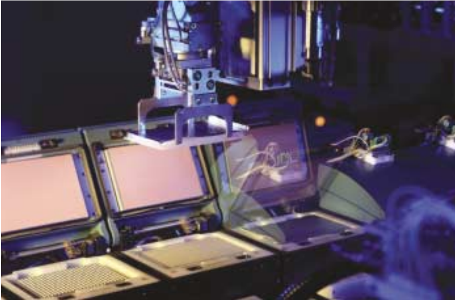
Hochdurchsatz Analysen: Modernste Automationstechnik macht ein vollautomatisches Bestücken und den parallelen Betrieb von bis zu 11 384er Thermo-Cyclern möglich.
