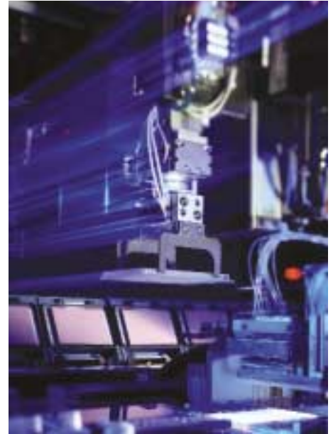
Hochdurchsatz Analysen: Modernste Automationstechnik macht ein vollautomatisches Bestücken und den parallelen Betrieb von bis zu 11 384er Thermo-Cyclern möglich.
