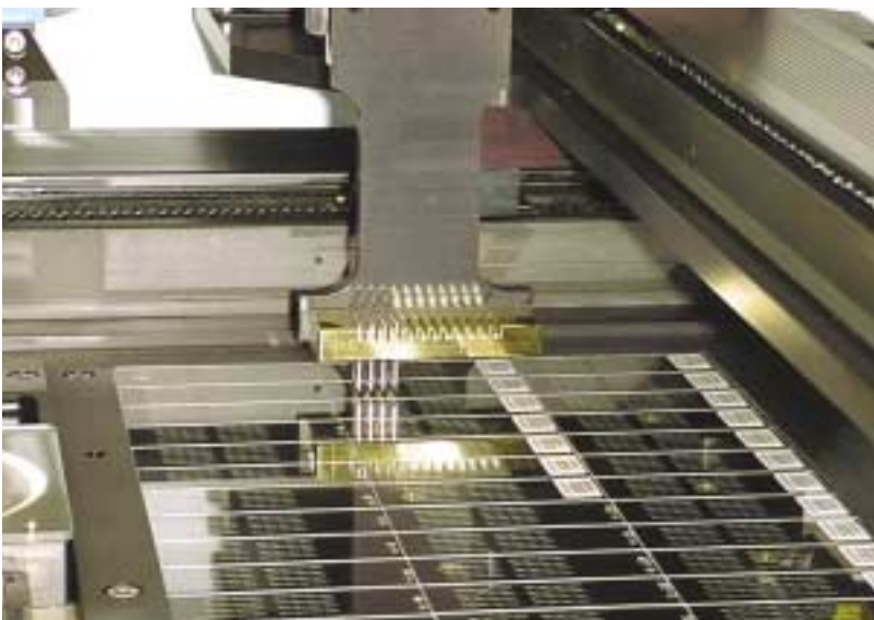
Abb. 1: SDDC-3 Microarrayer (Virtek Vision, Kanada) mit 16 Nadeln im Druckkopf während eines Laufs.
