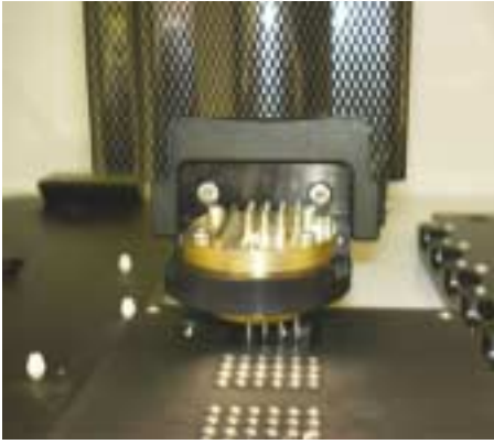
Abb2: Mittels Robotertechnik werden die exprimierten und aufgereinigten rekombinanten Proteine auf Chips aufgebracht. Anschließend können verschiedene Analysen direkt auf dem Chip durchgeführt werden.
