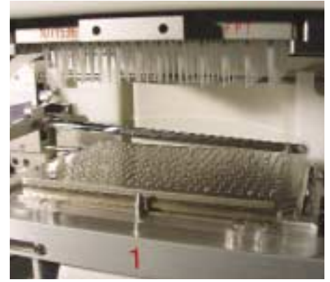
Proteinproben von A. thaliana werden über hochauflösende 2D-Gele aufgetrennt. Über automatisierte Verfahren werden die Proteinspots ausgestochen (Abb. 3), die Proteine aus dem Gel isoliert und schließlich auf entsprechende Träger zur MS-Analyse aufgebracht. (Abb. 4)
