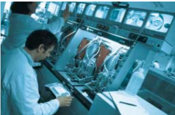
Durchführung eines komplexen zellulären Tests im Hochdurchsatz auf der EVOscreen, Mark-III Anlage, Evotec OAI Hamburg
