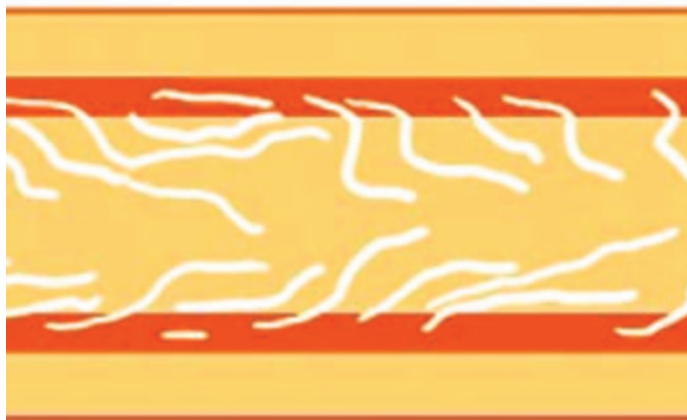
Abb.: Lehrmeister Natur: Das Modell der Zellwand zeigt die Hemizellulosen (weiß) als Teil der weichen Matrix (hell orange), die wie kleine Arme an die steifen Zellulosefibrillen (dunkel orange) angekoppelt sind. Bild: MPI für Kolloid- und Grenzflächenforschung / Burger
